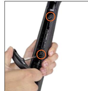
Beide Vorderschaftabschluss-Befestigungsschrauben mittels Inbus-Schlüssel (SW5) lösen und mit den Sicherungsscheiben herausnehmen.
